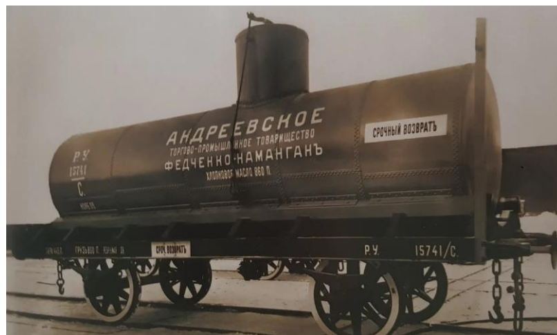
Рисунок 1.1 – 2-х осная цистерна нормально типа. Фото из книги "История грузовых железнодорожных перевозок в России XIX-XX века [42]
